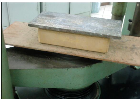
Figura 1 – Regularização das faces de trabalho por meio das chapas metálicas
