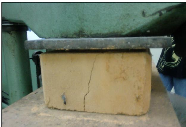
Figura 2 – Ensaio à compressão simples
