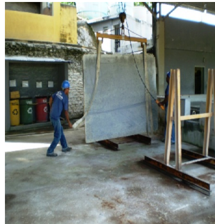
Figura 2 – M4 – Movimentação – chapas brutas para o P3 (Polimento – Polideira)
