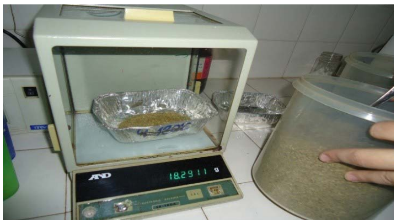
Figura 3. Balanza digital de precisión para obtener distintas muestras.
