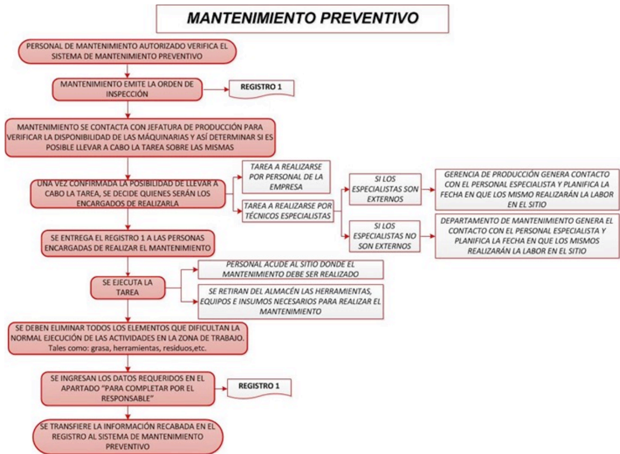
Figura 5. Procedimiento de mantenimiento preventivo.
