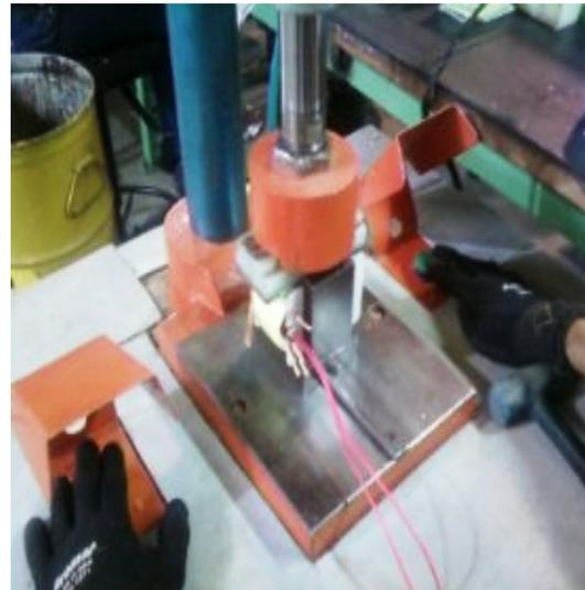
Figura 5 – Posto de prensar bobinas após as modificações
