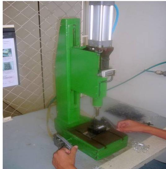
Figura 3 – Posto de cravar os terminais após as modificações
